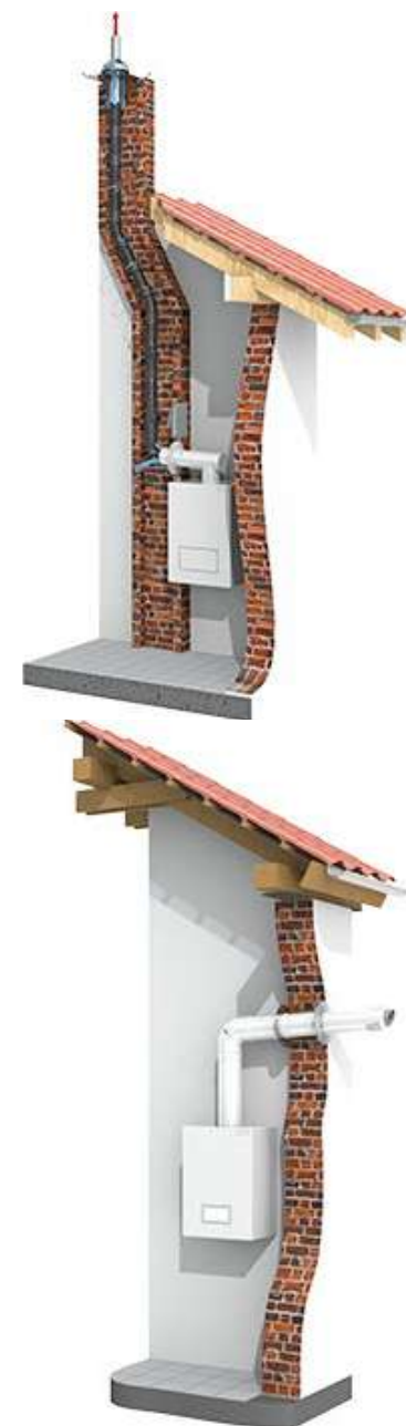
Exemple de chaudière à ventouse avec conduit d'extraction mural. Cette solution n'est pas compatible avec une rénovation patrimoniale.
