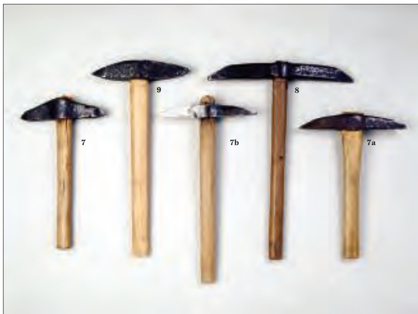
Fig. 2 – Outils de taille et mise en forme. N° 7, 7a, 7b, 8 et 9: pics symétriques. (Cliché J. Mongreville © Inventaire général, ADAGP, 2000)
