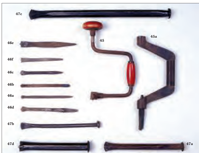
Fig. 8 - Percage. N° 45 : vilebrequin; n° 45a : vilebrequin (manque la conscience volante); n° 46a, 46b, 46c et 46d : mèches langue d'aspic; n° 46e et 46f : mèches à têtou; n° 47a : fleuret; n° 47b : tamponnoir; n° 47c : grand tamponnoir; n° 47d : « batte à beurre ». (Cliché J. Mongreville © Inventaire général, ADAGP, 2000)
