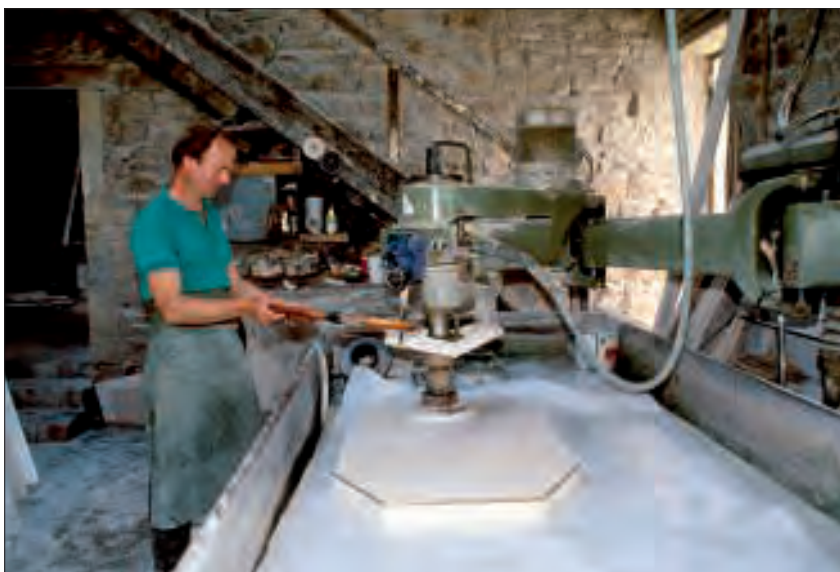
Fig. 13 – Polissage d'un dessus de table en marbre à l'aide d'un polissoir à genouillère (Balanod, Jura). (Cliché Y. Sancey © Inventaire général, ADAGP, 1997)
