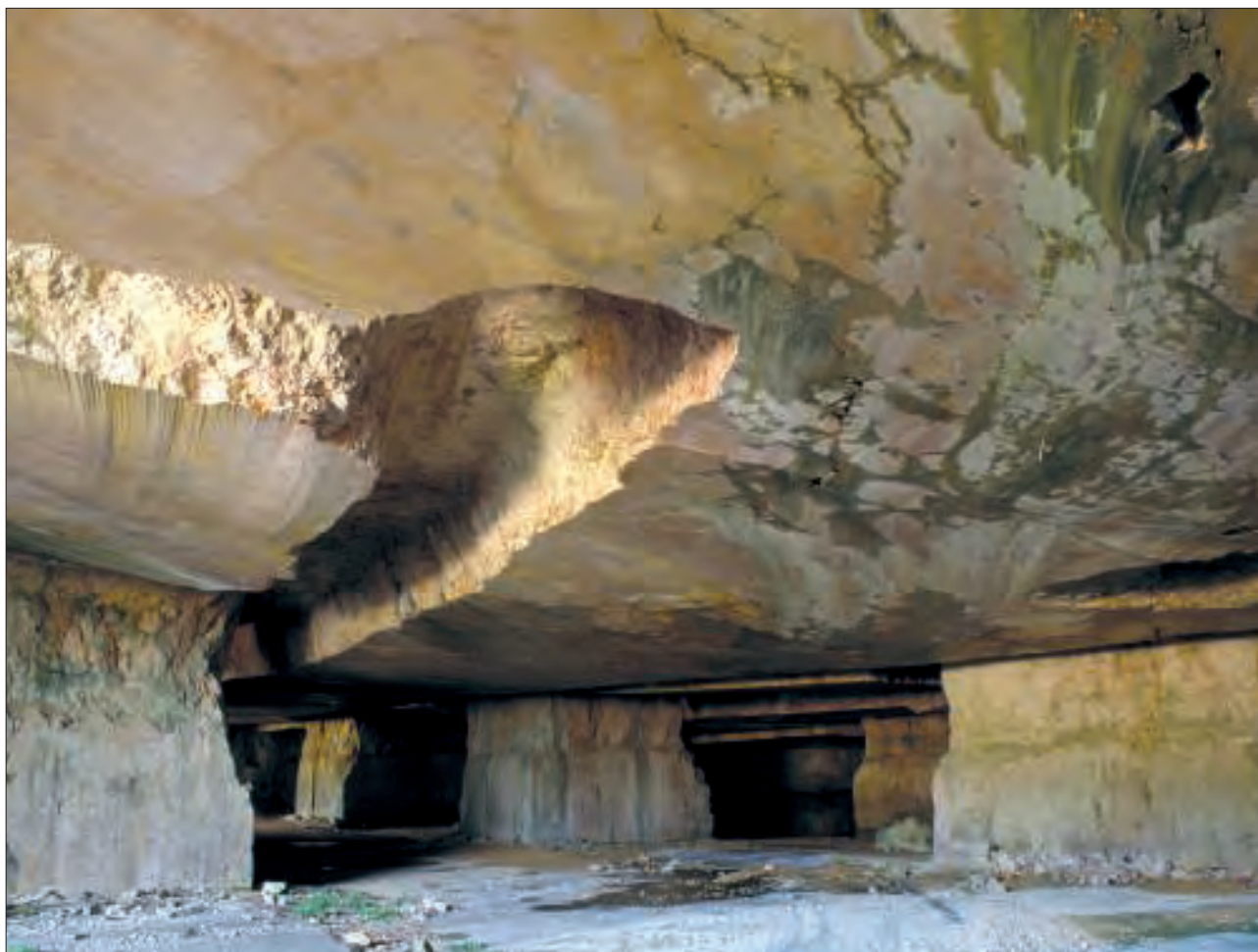
Fig. 9 – Intérieur de la carrière de Chassal (Jura), montrant au plafond les vestiges des galeries creusées pour le passage du fil hélicoïdal. (Cliché Y. Sancey © Inventaire général, ADAGP, 1997)
