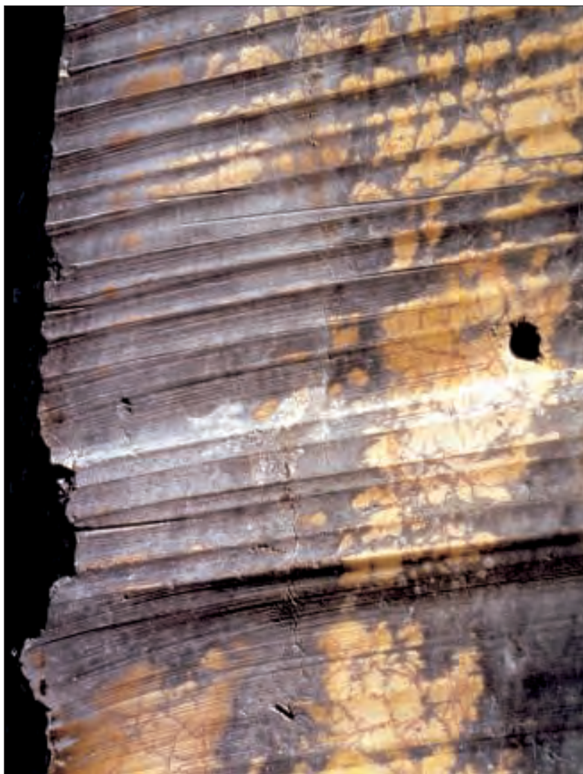
Fig. 5 – Pratz (Jura), carrière de Champied. Trace de sciage du fil hélicoïdal. (Cliché Y. Sancey © Inventaire général, ADAGP, 1997)
