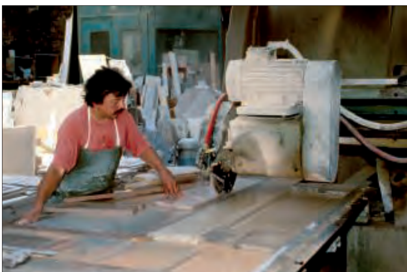
Fig. 10 – Débitage de marbre de Balanod pour réaliser des plinthes, marbrerie Yelmini Artaud (Balanod). (Cliché Y. Sancey © Inventaire général, ADAGP, 1997)
