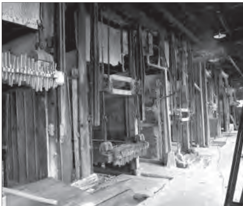
Fig. 7 – Vue d'ensemble des châssis multilames Décamps avant leur suppression, ancienne marbrerie Célard, actuellement Yelmini Artaud (moulin Febvre, Saint-Amour). (Cliché Y. Sancey © Inventaire général, ADAGP, 1993)
