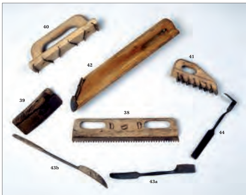
Fig. 7 - Sciage et rainurage, surfaçage et lissage. N° 38 et 39 : sciottes; n° 40 : chemin de fer; n° 41 : rabotin; n° 42 : guillaume à pierre; n° 43a et 43b : rifloirs; n° 44 : gratte-fond. (Cliché J. Mongreville © Inventaire général, ADAGP, 2000)
