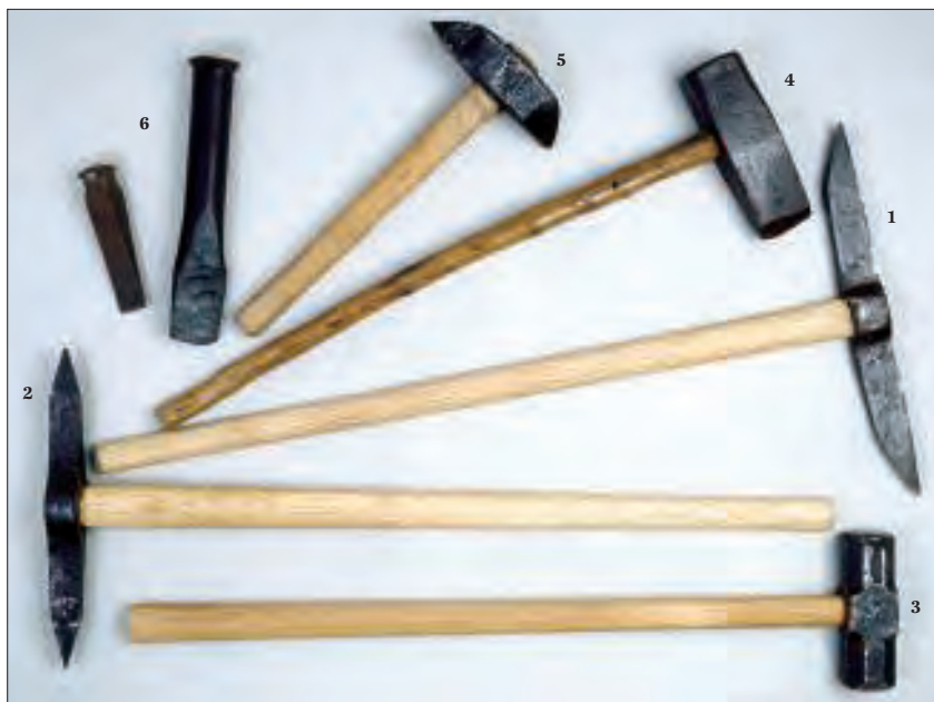
Fig. 1 – Outils liés à l'exploitation et au débitage de la pierre. N° 1 : escoude ; n° 2 : rivelaine ; n° 3 et 4 : masses ; n° 5 : pic (de carrier) ; n° 6 : coins. (Cliché J. Mongreville © Inventaire général, ADAGP, 2000)
