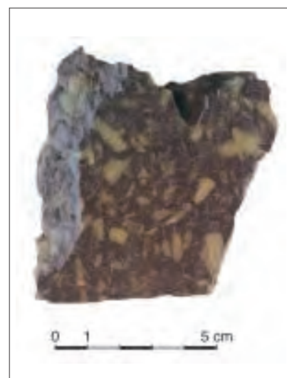
Fig. 10 - Besançon (Doubs), Le Refuge, rue Lecourbe. Fragment de plaque de porphyre; la matrice de fond (andésite) de l'échantillon possède une coloration hybride insolite, brun-vert, presque violacée, les phénocristaux sont irréguliers et jaunâtres; lieu d'extraction indéterminé (Vosges, Massif central, secteur de Fréjus en Gaule; ou Grèce...). (Cliché J. Mongreville © Inventaire général, ADAGP, 2002)
