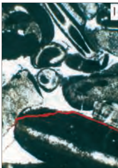
Fig. 16 - Observation en lame mince d'un marbre de Sampans, faciès à oncolithes. Les allochèmes (oncolithes, entroques et autres bioclastes) sont fortement cimentés par le ciment calcitique (en clair). Présence d'une porosité fissurale au niveau d'un joint ouvert (en rouge vif).
