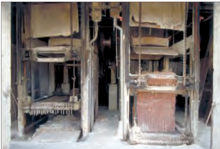
Fig. 12 – Deux armures Décamps vues de face en 1993, à la marbrerie Célar (moulin Febvre, Saint-Amour, Jura). Des coins métalliques (visibles à l'avant du cadre porte-lames) maintiennent les lames en tension. (Cliché Y. Sancey © Inventaire général, ADAGP, 1997)
