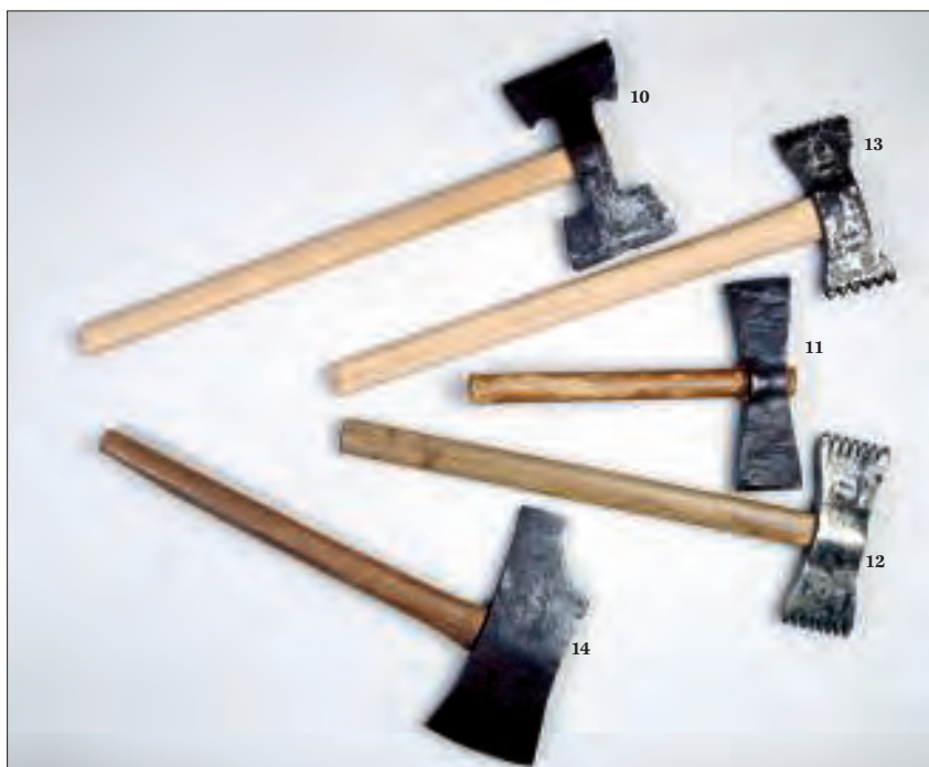
Fig. 3 – Outils de taille et mise en forme. N° 10 et 14: taillants droits; n° 11: taillant brettelé; n° 12: rustique; n° 13: marteau grain d'orge. (Cliché J. Mongreville © Inventaire général, ADAGP, 2000)
