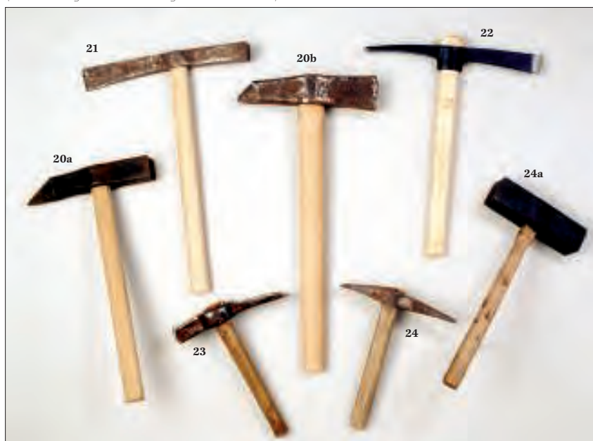
Fig. 5 – Outils liés au débitage de la pierre et marteaux à pierre. N° 20a et 20b: pics-têtes; n° 21: taillant-tête; n° 22: décintoir; n° 23: marteau taillant (grelet?); n° 24: taillant-pic; n° 24a: tête symétrique. (Cliché J. Mongreville © Inventaire général, ADAGP, 2000)
