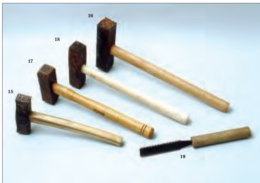
Fig. 4 – Outils de finition. N° 15: boucharde marteline; n° 16-18: bouchardes droites; n° 19: dégrasse-boucharde. (Cliché J. Mongreville © Inventaire général, ADAGP, 2000)
