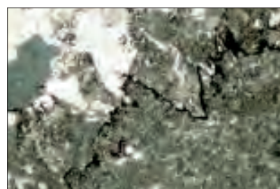
Fig. 10 – Calcaire bioclastique et graveleux bréchique, Crétacé inférieur (Barrémien), Chassal: lame mince de Brocatelle jaune. Un joint stylolithique de dissolution sous contrainte est souligné par un liseré sombre d'insolubles. (Cliché M. Rossy, 1997)
