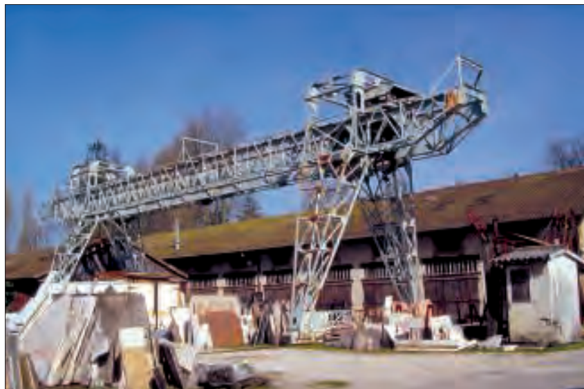
Fig. 3 – Portique roulant de l'ancienne marbrerie Célar, actuellement Yelmini Artaud (moulin Febvre, Saint-Amour). (Cliché Y. Sancey © Inventaire général, ADAGP, 1994)
